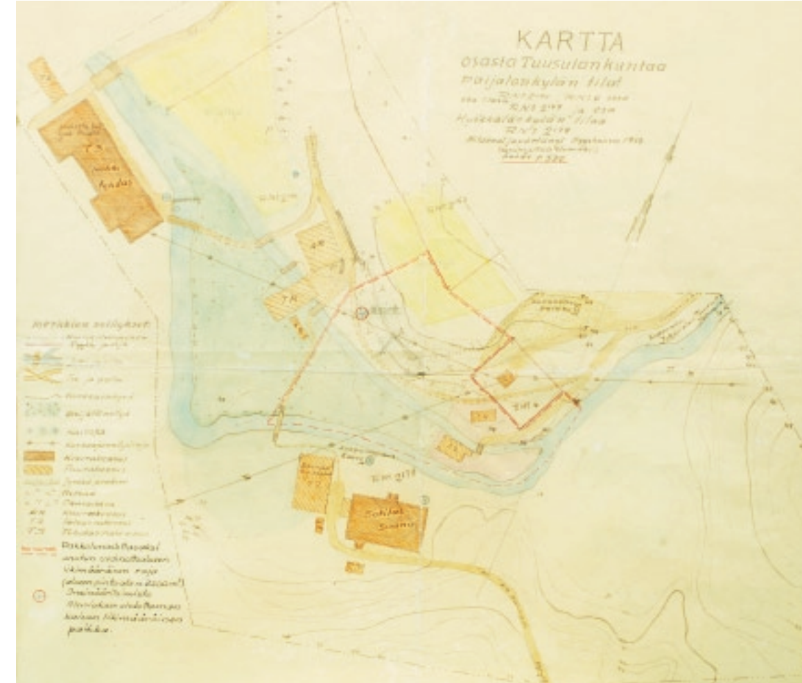
Kuva 1.4 Suunnitelma Keravan kauppalan ensimmäisestä vedenottamosta Pajjalankylässä vuodelta 1950.
